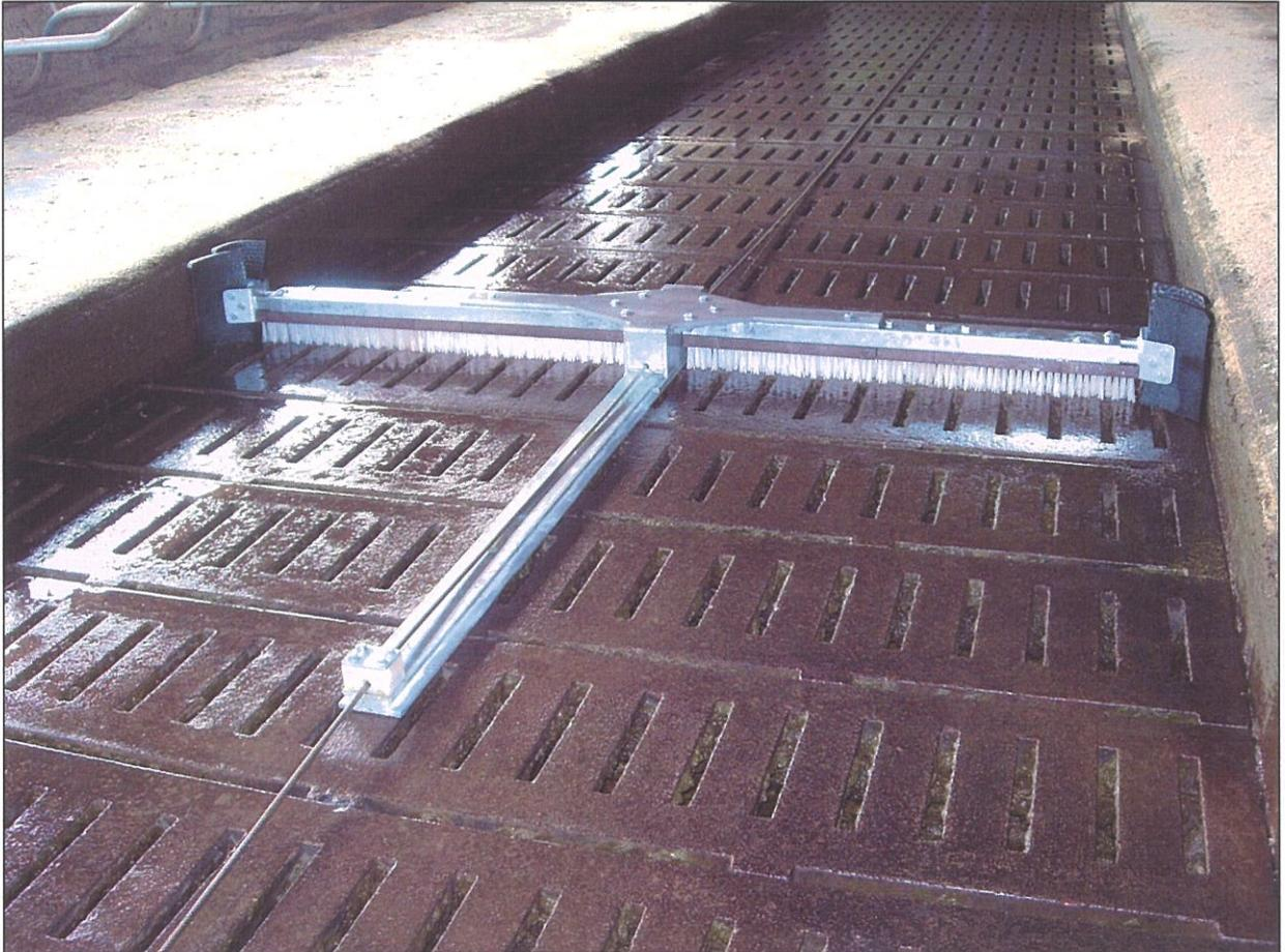
Mit dem Spaltenbodenschieber DeltaBrush führt DeLaval eine Neuheit zur Reinigung von Spaltenböden ein.
