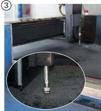
entsprechend der erstellten CAD-Zeichnung werden die Schlitze mit innovativer Wasserstrahl-Schneidetechnologie passgenau in die Matten geschnitten
